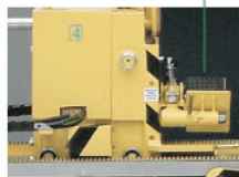
Carreto principal com sistema de trava de feixe tubulares
