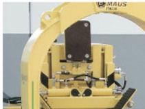
Balancín circular para la elevación
