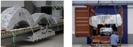
*El balancín puede ser desmontado en tres piezas para transportarlo en un contenedor para lograr un almacenamiento más sencillo de la máquina.*
