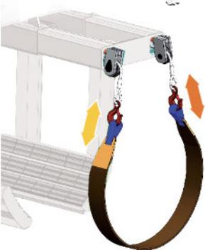
*Cables regulables e independientes. Permite compensar cualquier error de posicionamiento asimétrico de las bandas de "asiento" posicionadas debajo del haz tubular.*
