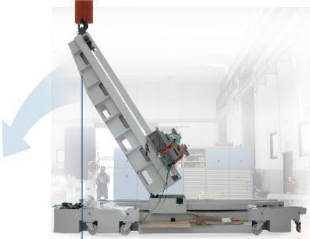
La capacidad de inclinarse del **MA 2501** hace que la máquina sea conveniente para cualquier tipo de transporte
